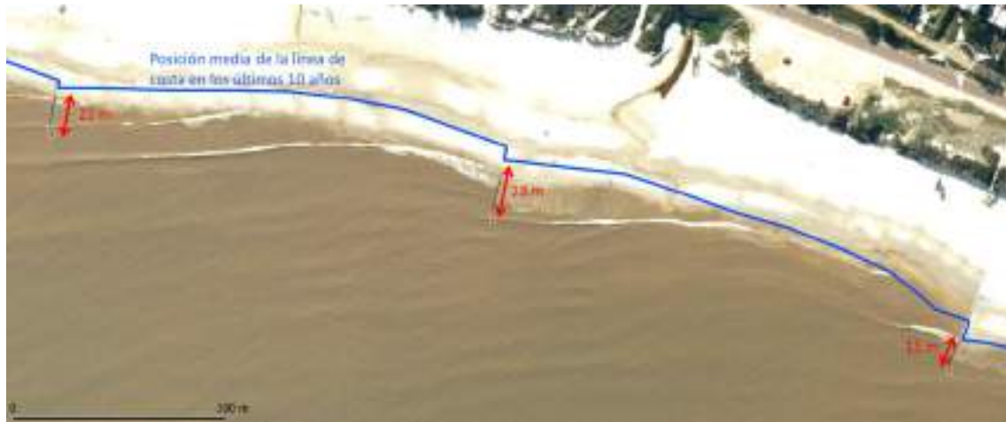
Figura 4-85 Ejemplo de distancia entre línea de costa media de los últimos diez años y el morro de los espigones existentes.
