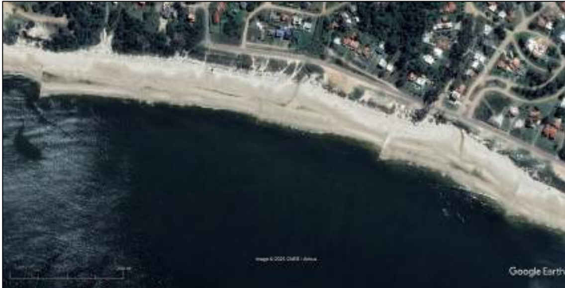
Figura 4-34 – Foto satelital de octubre de 2013. Solo algunos de los espigones muestran acumulación de arena en su lado Este; otros parecen completamente tapados de arena.
