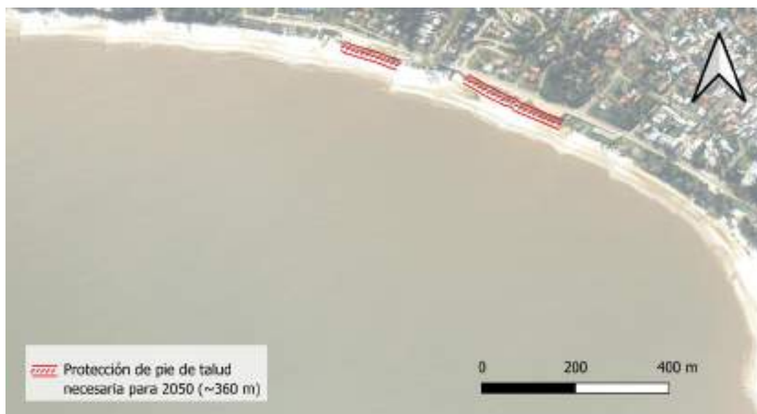
Figura 4-71 – Protección de pie de barranca o talud, asumiendo que no hay avance de la línea de costa, para un aumento del NMM de 20 cm.
