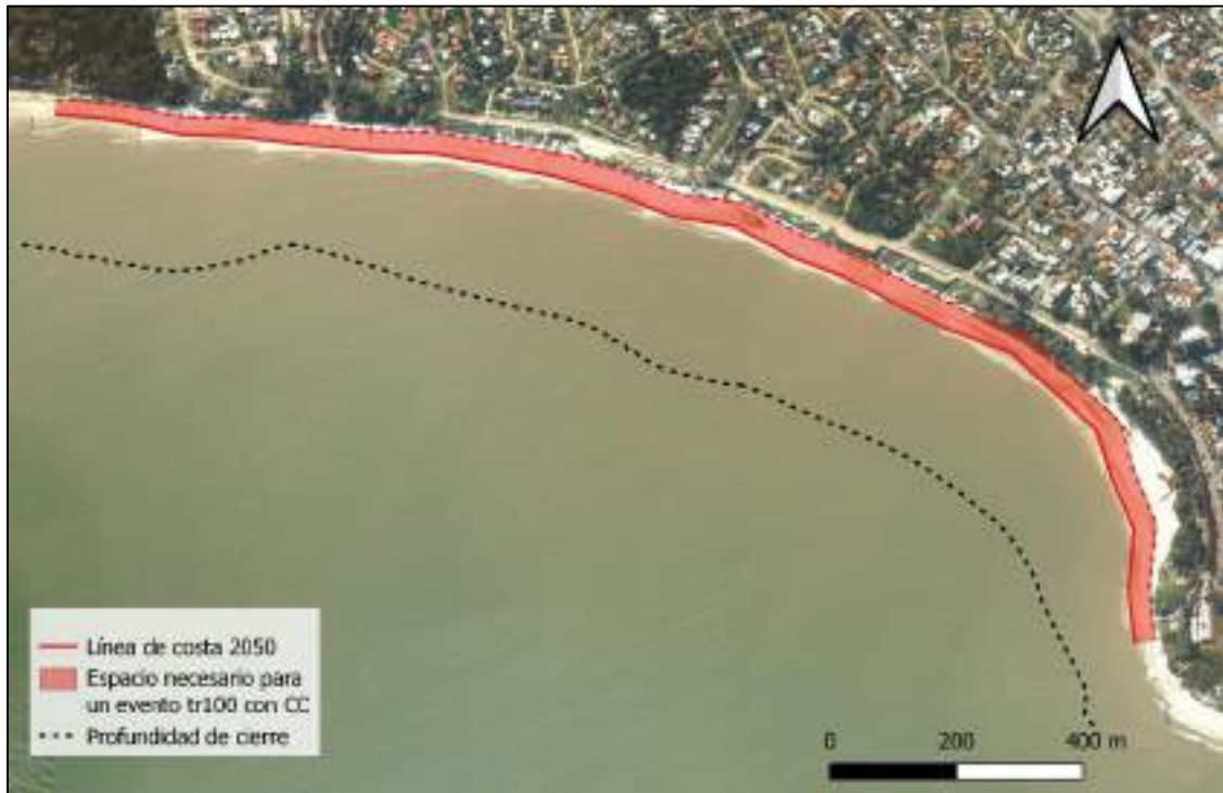
Figura 4-59 – Línea de costa proyectada para 2050, considerando aumento del nivel medio del mar de 20 cm, y franja de variabilidad del perfil de playa considerando retroceso del perfil de 100 años de período de retorno.
