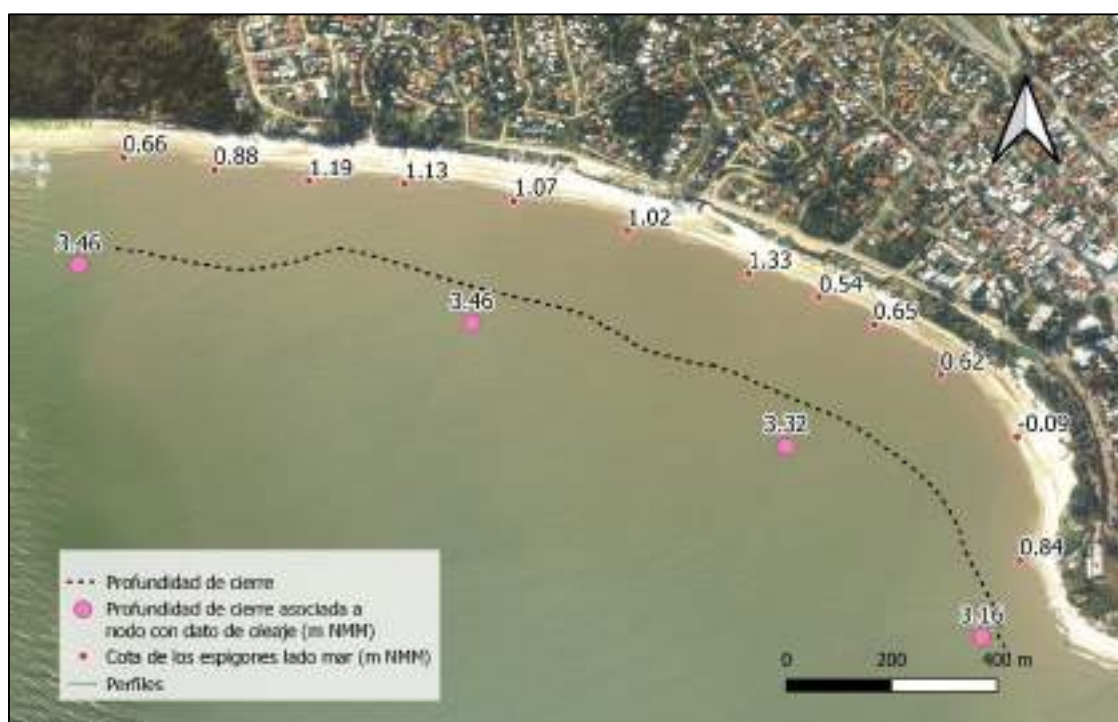
Figura 4-44 – Profundidad de cierre calculada para cada nodo de oleaje (puntos violetas), curva estimada de posición en planta de la profundidad de cierre (línea cortada) y ubicación y profundidad de los morros de los espigones (puntos rojos). Cotas respecto a NMM, positivo hacia abajo.
