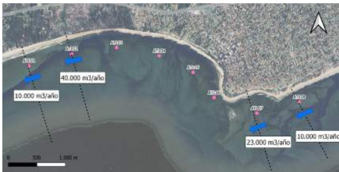
Figura 4-28 - Transporte litoral neto estimado para la zona. Se muestra el resultado del transporte neto.
