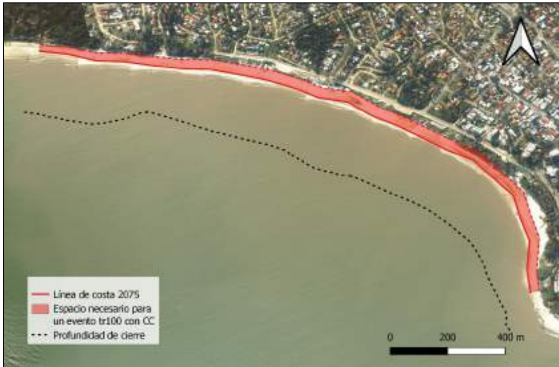
Figura 4-60 – Línea de costa proyectada para 2075, considerando aumento del nivel medio del mar de 40 cm, y franja de variabilidad del perfil de playa considerando retroceso del perfil de 100 años de período de retorno.
