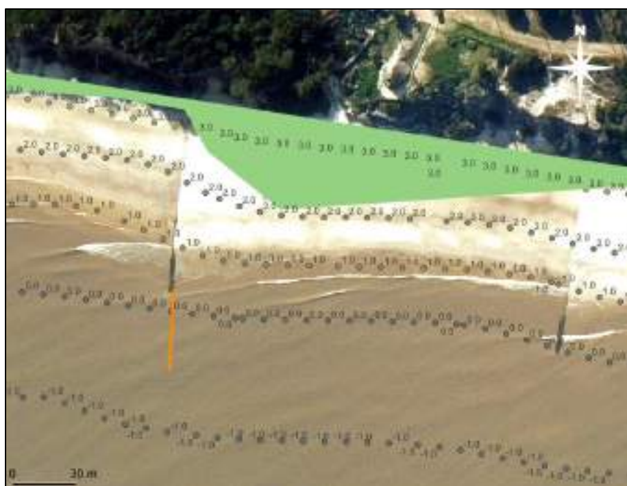
Figura 4-91 Esquema de la extensión del espigón ubicado al Oeste del Águila (en naranja) e información batimétrica proporcionada por la Intendencia de Canelones (puntos; cotas en metros referidas al cero Wharton).
