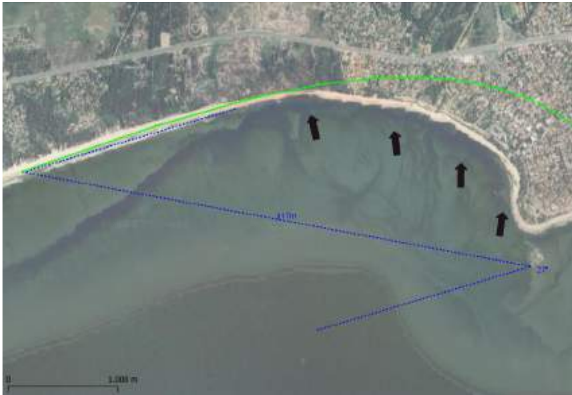
Figura 4-26 – Forma de equilibrio estático en planta a largo plazo para el arco de playa desde Marindia a Atlántida (playa Mansa), considerando como punto de difracción del oleaje la Isla de la Sirena.
