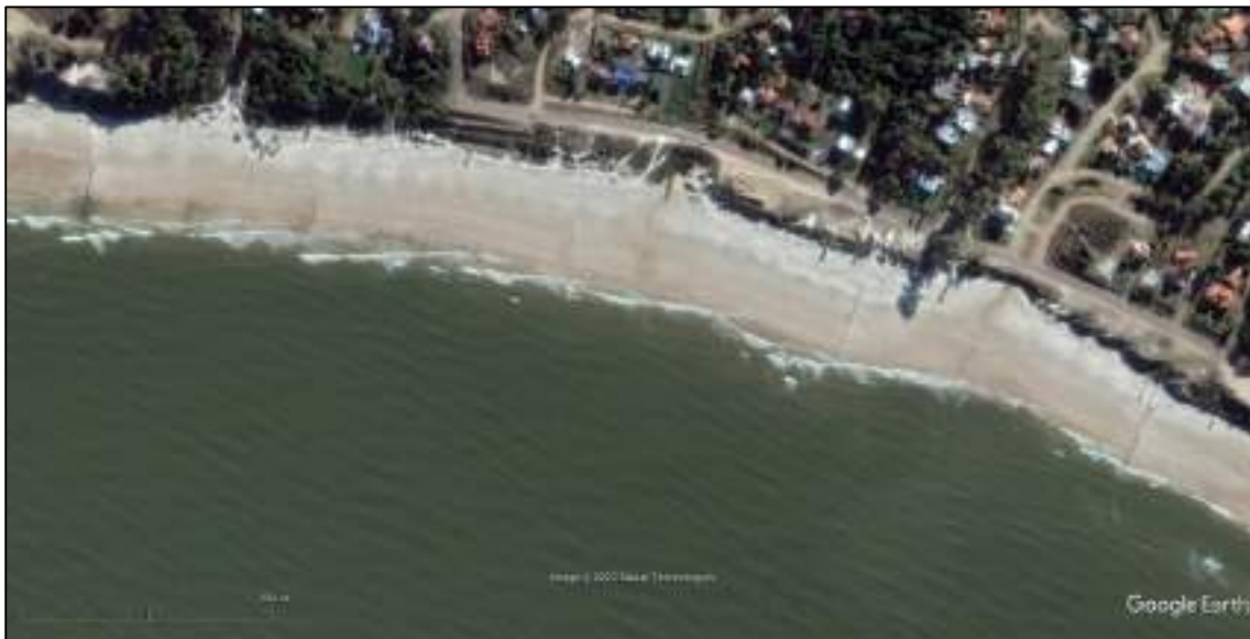
Figura 4-35 – Foto satelital de julio de 2015. En general no se observa diferencia en la acumulación de arena entre los lados Este y Oeste de los espigones.
