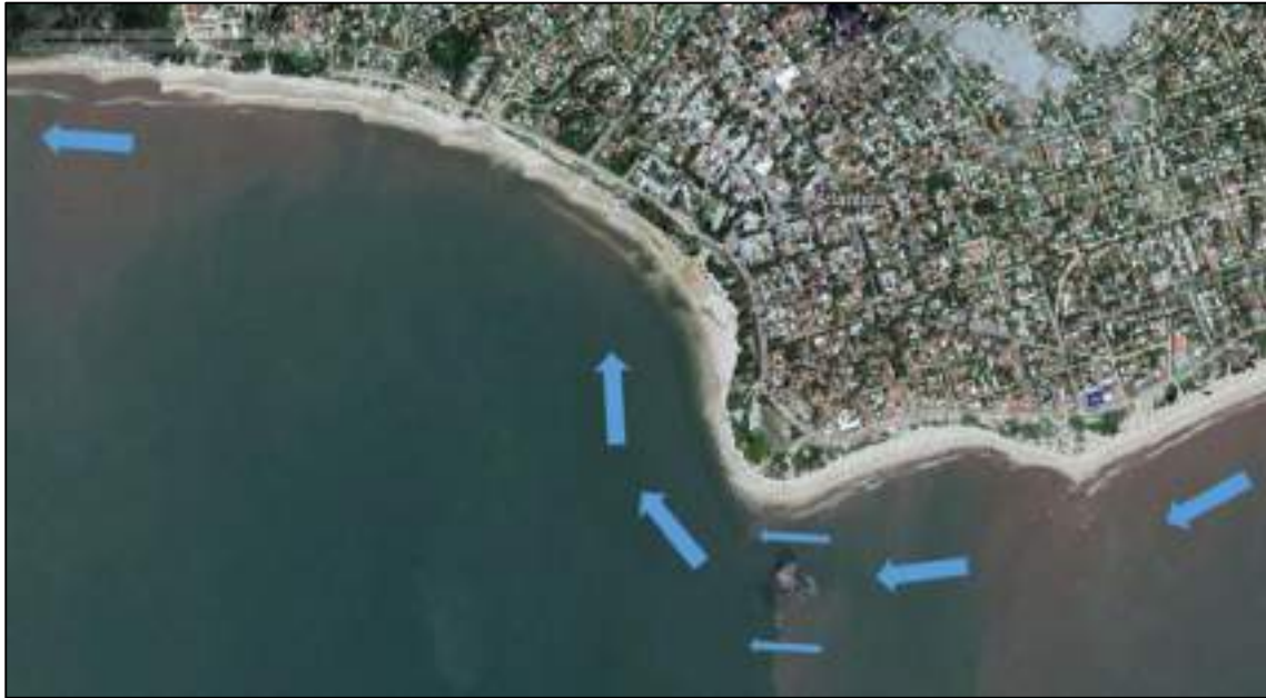
Figura 4-30 - Esquema de bypass de arena a través de punta de Atlántida.
