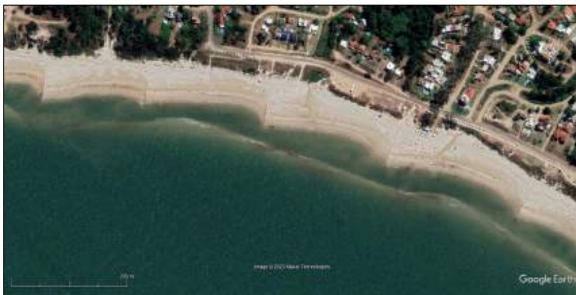
Figura 4-33 – Foto satelital de febrero de 2020. En todos los espigones se observa acumulación de arena en su lado Este.
