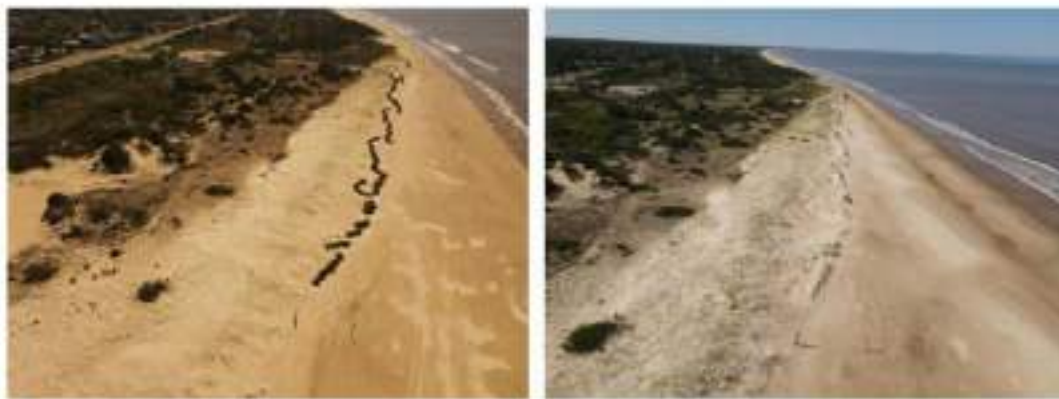
Figura 4-103 Resultados antes y después de colocación de cercas en Ciudad de la Costa (proyecto Municipio Ciudad de la Costa, Organización local Guardianes de la Costa)
